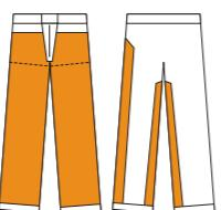
Le type **B** est identique au type A avec un retour supplémentaire de 5 cm à l'intérieur de la jambe gauche.Type **B** is identical to type A, but has an extra 5 cm of protection to the interior part of the left leg.**NORMES EN 381-7 : 2000****PROTECTIONS DES MAINS POUR LES UTILISATEURS DE SCIE À CHAINE.**
