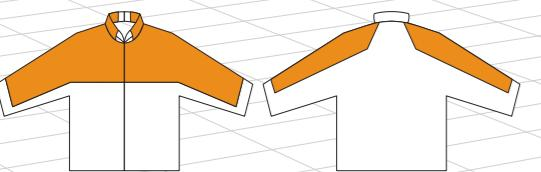
Les deux images décrivent la surface de protection nécessaire. Sur la face avant des manches la surface de protection doit couvrir minimum 80% et doit s'arrêter à moins de 70 mm du bas de manche.
