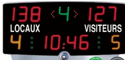
Portable idéal pour les clubs, se pose sur la table de marque, léger, facile à transporter. Disponible sur batteries (autonomie d'environ 20h00) ou sur secteur. Modèle multisport (basket, hand, volley, tennis, tennis de table, foot en salle, badminton, hockey), avec une lisibilité de 35m. Livré avec un pupitre de commande radio, avec avertisseur sonore intégré. Chiffre de 9cm. Dimensions : 733 x 368 x 1150mm.
