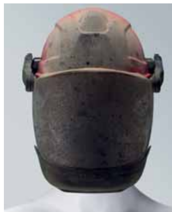
Après un arc électrique de 7 kA
